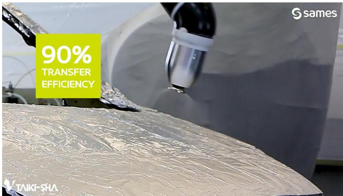
通过实现高涂着效率，减少涂料浪费，降低 VOC 排放量。将涂料飞溅控制在最小，可减低通风风速，进而降低能耗。同时，清扫作业变得更加便捷，有助于降低健康风险。
