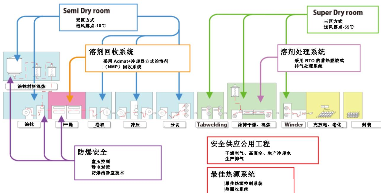
作为空调、排气处理的综合解决方案，我们将提供低成本、省空间且高性能的干燥室（低露点制造室）。特别是具有划时代意义的 NMP Recovery System，其在维护性、节能、运行成本方面表现出色，并且拥有日本国内顶级实绩。
