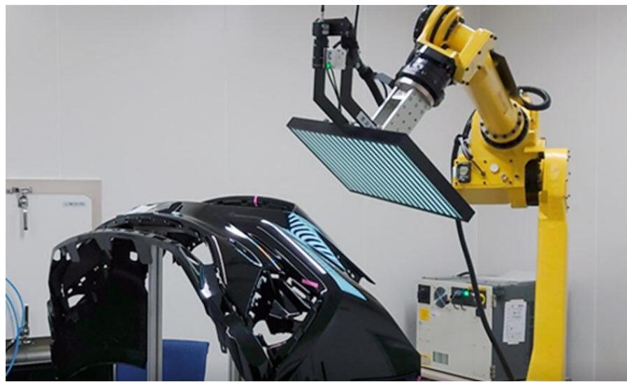
我们将针对涂膜的各种检测需求提出最佳方案，并为客户提供价值。本公司的系统为了做出作业人员同等水平的判断，在传统图像检测系统的基础上构建嵌入 AI 的学习系统，实现高精度的自动检测。我们同时还受理包括对现有设备改造等在内的各阶段引进咨询。
