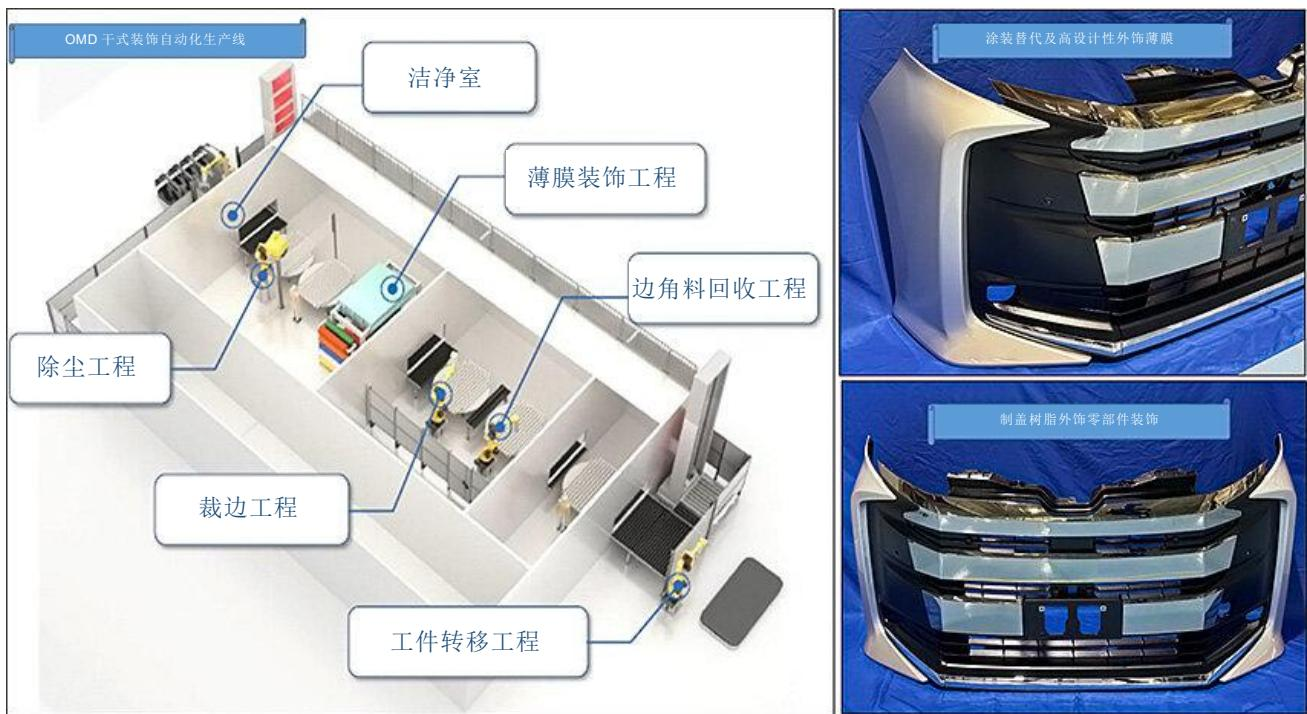
为了实现涂装工程的碳中和，我们正在摸索一种可替代传统喷涂涂装的涂装方式，并对各种装饰系统进行探讨。采用薄膜装饰贴合技术时，可省去喷涂涂装工程，从而实现低碳，且不需要排水排气处理装置，有望在环境方面凸显优势。
